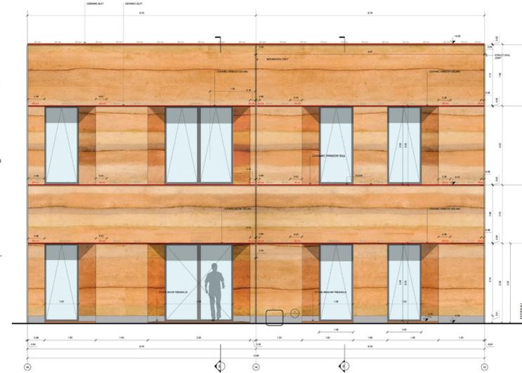
Disegno di dettaglio del muro in terra battuta, con l'inserimento di elementi orizzontali ceramici per interrompere il dilavamento da parte dell'acqua piovana. Detail design of the compacted ground wall with the insertion of ceramic horizontal elements to break the washout caused by the rain
