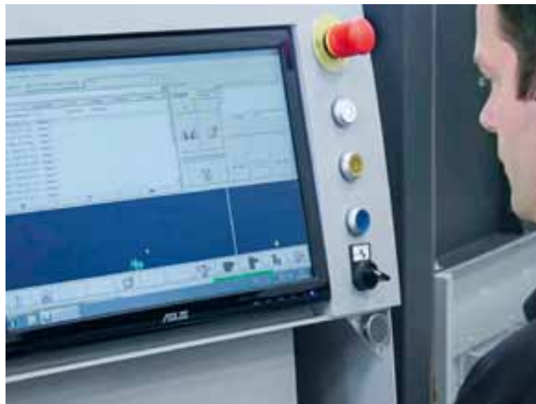
Zur einfachen Bedienung und Ansteuerung steht ein übersichtlicher Bedienterminal mit 18,5 Zoll TFT-Farbdisplay zur Verfügung.
